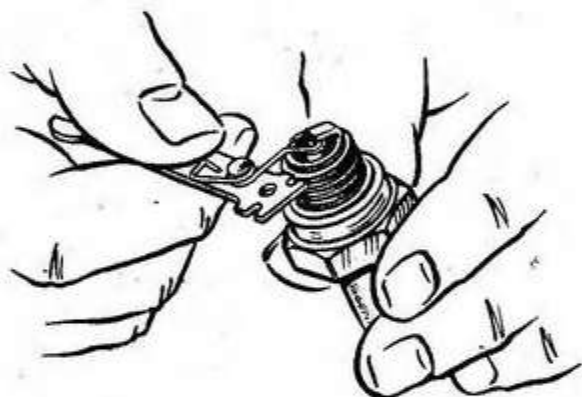
Рис. 215. Проверка зазора между электродами свечи
