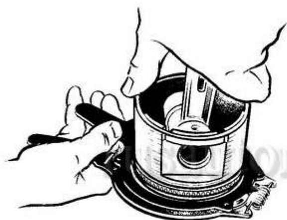
Рис. 51. Снятие поршневых колец с поршня
