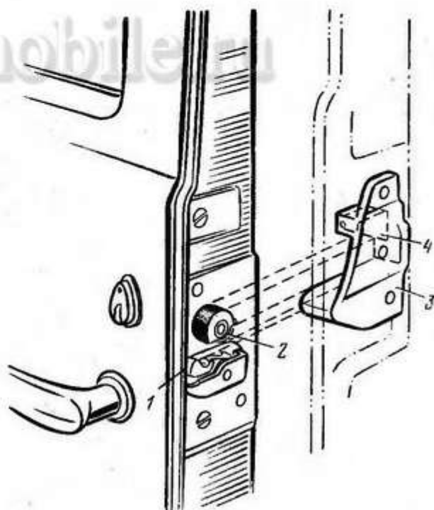
Рис. 260. Установка замка двери:
