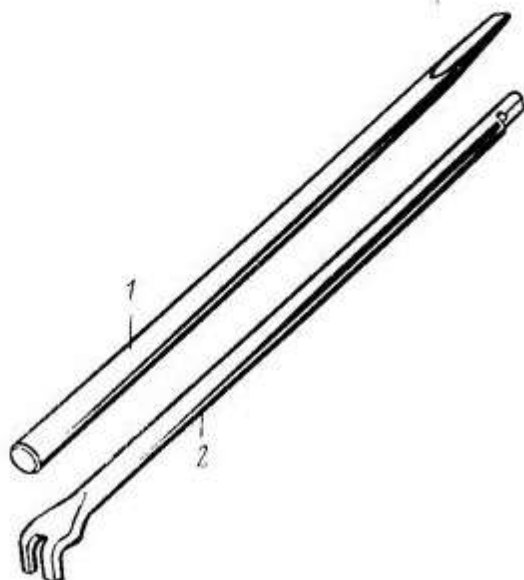
Рис. 127. Монтажные лопатки: 1—прямая; 2—вилочная
