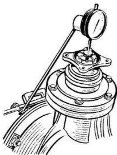
Рис. 112. Определение осевого люфта в подшипниках ведущей шестерни главной передачи
