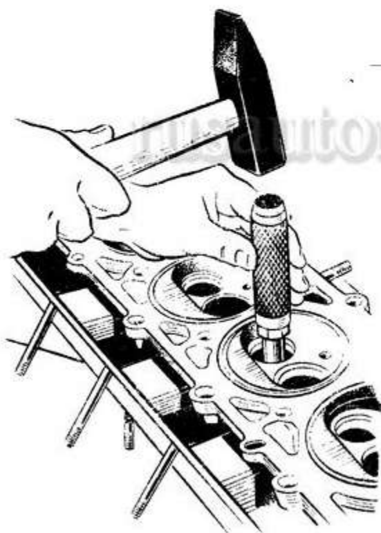
Рис. 57. Выпрессовка направляющих втулок клапанов
