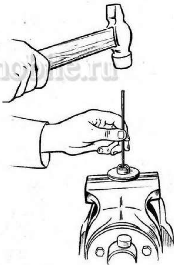
Рис. 165. Выпрессовка поршня из клапана управления
