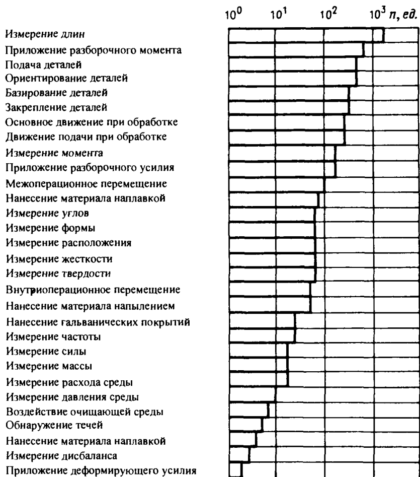
Рис. 1.5. Вариационный ряд количества технологических переходов n , отнесенных к восстановлению деталей одного ремонтируемого двигателя
