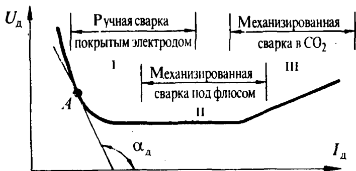
Рис. 3.14. Статическая вольт-амперная характеристика дуги
