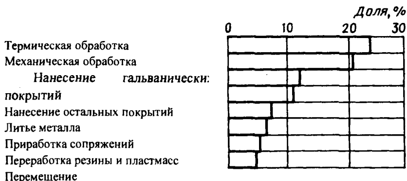
Рис. 1.15. Распределение расхода электрической энергии на основные технологические процессы ремонтного завода с восстановлением деталей
