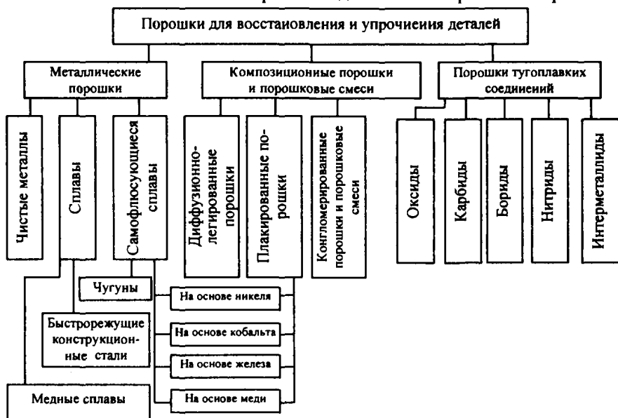
Рис. 3.6. Классификация порошков, применяемых для нанесения покрытий
