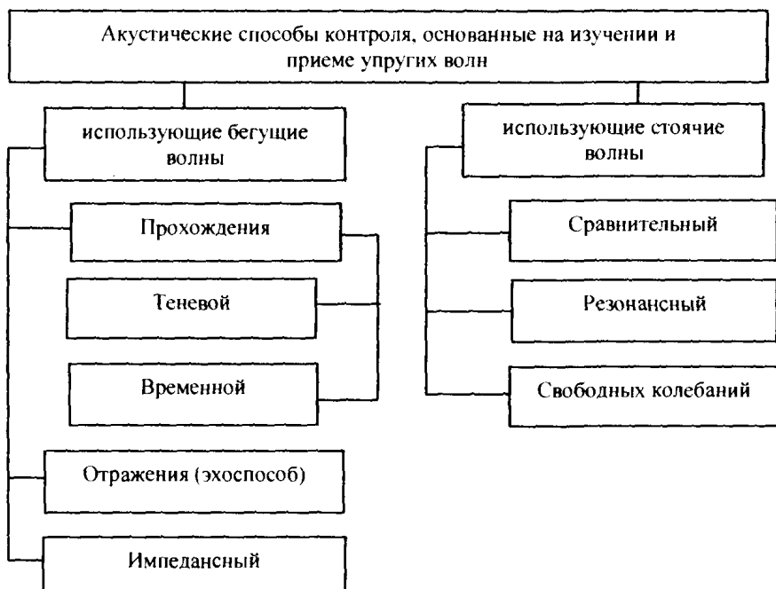
Рис. 2.12. Классификация акустических способов контроля
