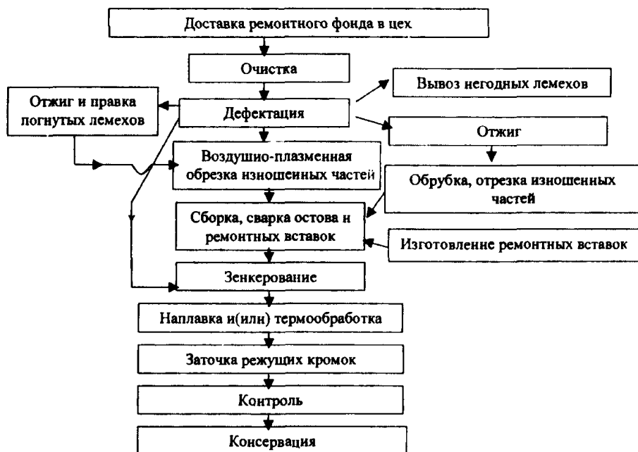
Рис. 6.18. Схема ТП восстановления лемехов
