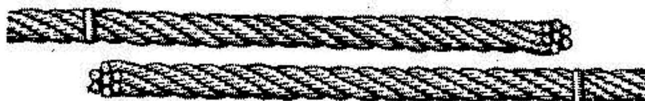
Рис. 151. Расположение концов стальных канатов перед счалкой
