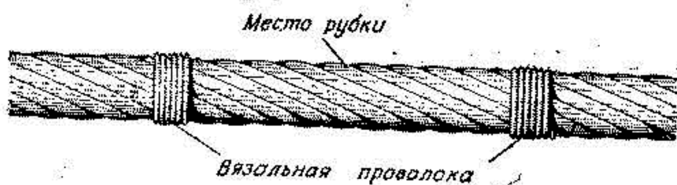
Рис. 143. Стальной канат, подготовленный к порубке
