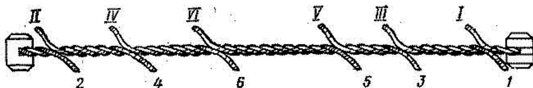
Рис. 153. Вид счаливаемого каната до заделки концов прядей
