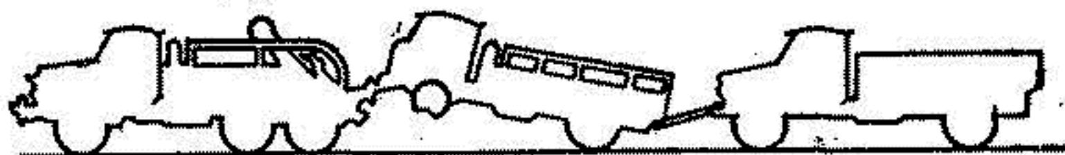
Рис. 116. Транспортирование объектов в полупогруженном положении и буксированием
